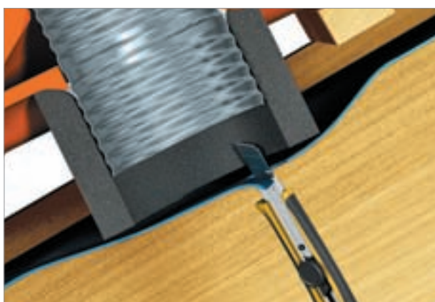
Abbildung 2: »Aufschneiden der Dachfolie«
